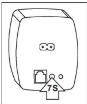
Per resettare il motore, con l'ausilio di un ago o una graffetta, bisogna premere il pulsante del motore per 7/10 secondi
