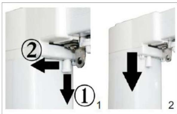
Per montare il motore bisogna inserire l'innesto di metallo nell'invito e spostare la leva per bloccarlo. In seguito bisogna schiacciare la leva per bloccarla a sua volta
